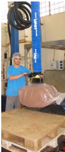
Typisk säcklyftsinstallation. Här: plasticsäcker med snabbkaffepulver.
