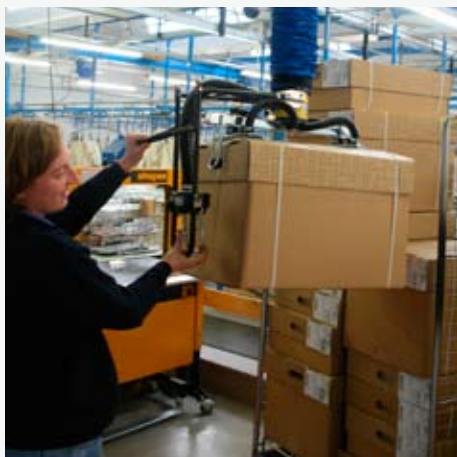
1. Ett flexibelt, förlängt handtag förvandlar höga lyft till ergonomiska lyft.
