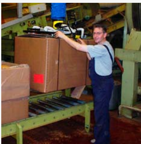
4. Stora, tunga kartonger, här i mekanisk tillverkande industri, lyfts utan problem med VacuMyggan.
