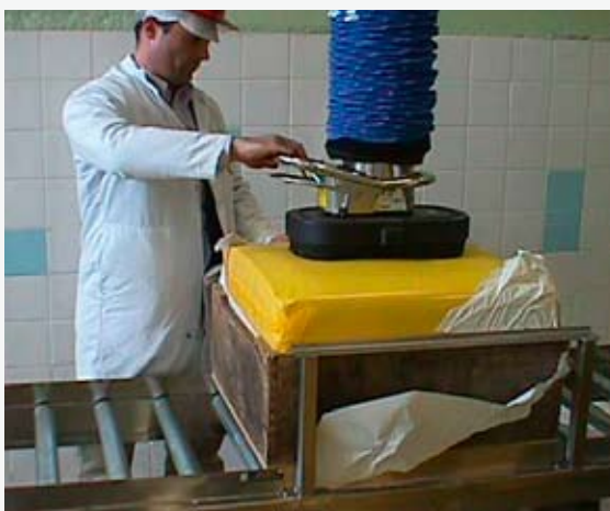
4. VM160 lyfter ostblock ca 60-70 kg. Livsmedelsindustrin har använt rostfria vakuumlifftar i produktionen i många år.
