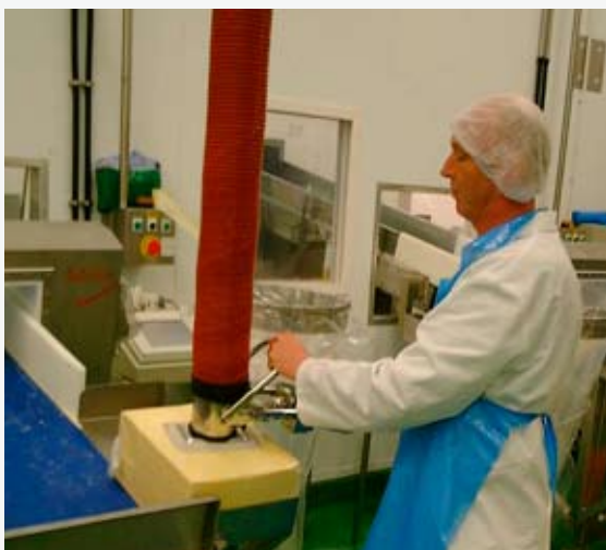
2. Modell VM120 med rostfritt standard handtag. Sugfot 630715, också i rostfritt.
