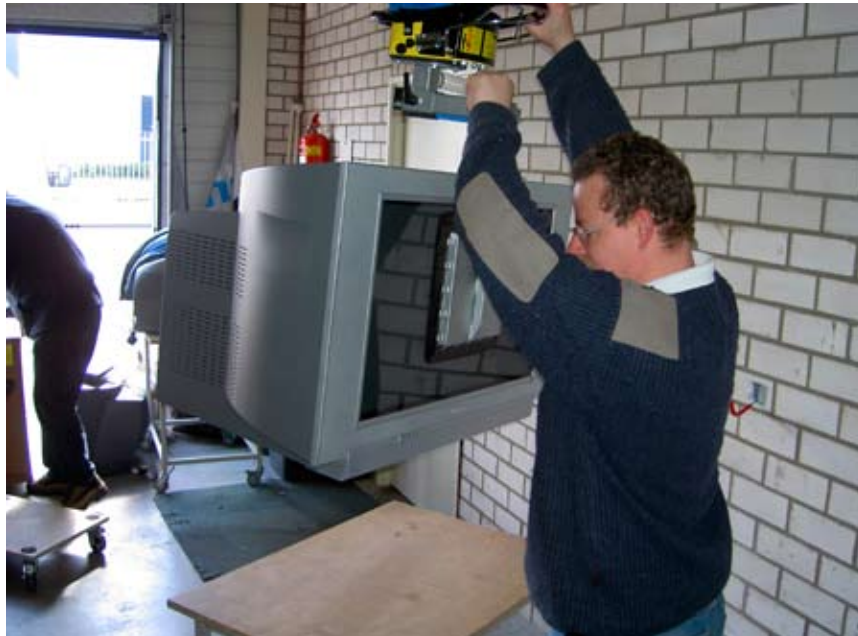
Projekt nr 2598. Sidolyft för TV-apparater med justerbar sugfot. Sugfoten är lågbyggd för att kunna passera ner i kartonger för att lyfta upp TV-apparaten. Modell VM160 med fast handtag.
