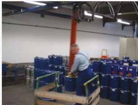
3. VM160 används för att lasta över tunnor ca 60 kg. Sugfoten i detta projektet är standardsugfot art nr 610230.
