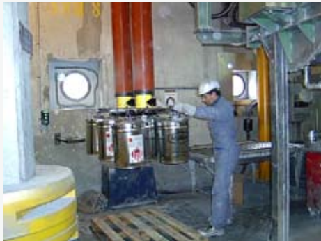
1. Kemisk tillverkande industri: VM2200 med special sugfot som lyfter 8 burkar i taget. Sugfotens projektnr 2578.
