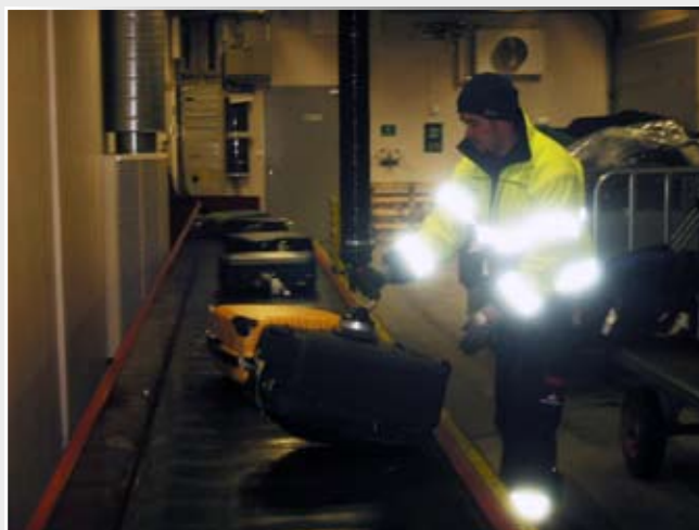
Vakuumlyftar är ett utmärkt lyfthjälpmiddel i flygplatsernas bagagehantering. Kombinerad med vår högflödes vakuumpump kan VacuCobra lyfta bagage som väger upp till 50 kg.
